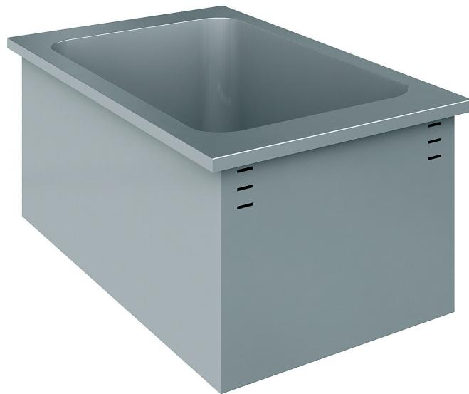
Vasca bagnomaria da incasso, realizzata in acciaio inox AISI 304. Regolazione della temperatura da +30°C ÷ +80°C tramite termostato. Vasca raggiata e stampata, profondità h. 215 mm. Struttura in acciaio inox AISI 304. Mantenimento automatico del livello dell'acqua.
