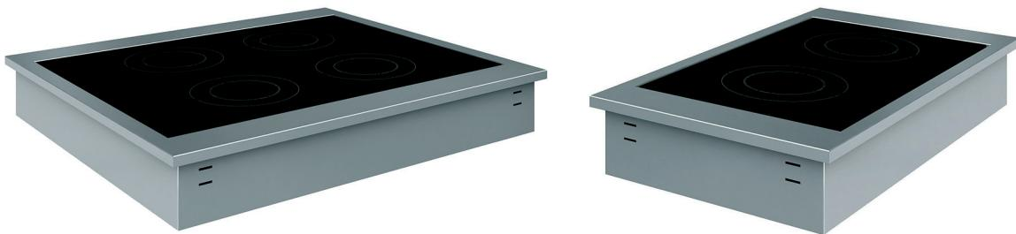
Piano di cottura da incasso in vetroceramica ad induzione a 2 o 4 zone di cottura. Riscaldamento con sistema di generazione del calore per effetto induttivo attivato dalla presenza di un recipiente metallico sul piano di cottura, disattivandosi quando questo viene tolto. Struttura realizzata in acciaio inox AISI 304. Regolazione precisa della temperatura tramite regolatore continuo di potenza.
